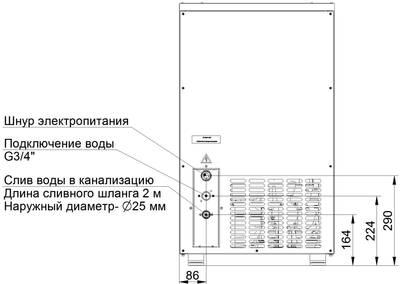
Рис. 4 Схема подключения льдогенератора
